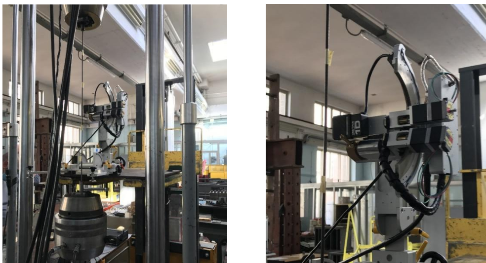
FIGURA 8.2: MISURA DELLO STATO TENSIONALE SU FILO DI PRECOMPRESSIONE MEDIANTE DIFFRATTOMETRO GNR PRESSO IL POLITECNICO DI TORINO, CENTRO SISCON "SAFETY OF INFRASTRUCTURES AND CONSTRUCTIONS".
