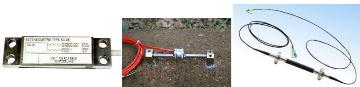
Figura 6.1: Esempi di estensimetri per misure di lungo periodo o su superfici irregolari
