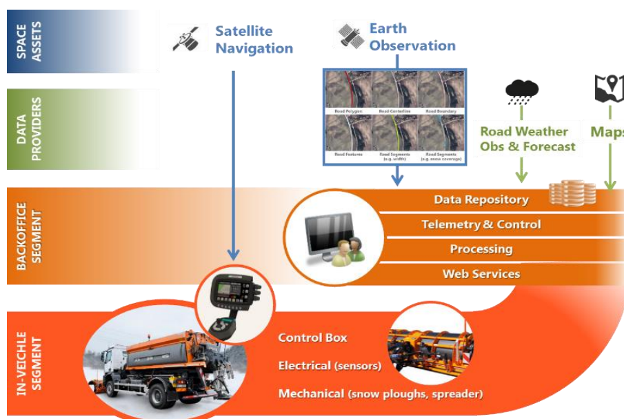
Figura 1 - Architettura logica del Sistema di Manutenzione Invernale in una Smart Road
