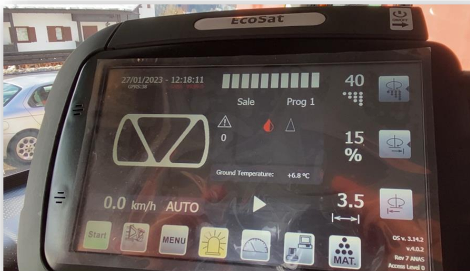
Figura 21 - Schermo gestione attrezzature su veicolo adibito a manutenzione invernale
