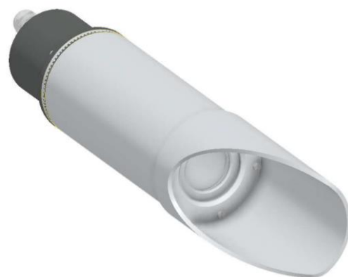
Figura 7 - Sensore di temperatura installato su Postazione meteo mobile
