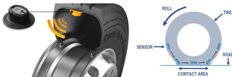
Figura 10 - Esempio di sensore per Smart Tire e funzionamento
