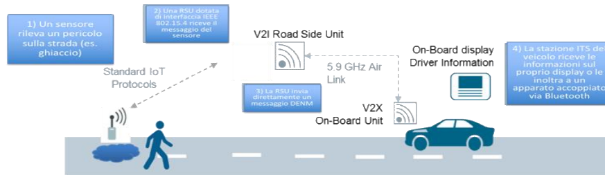
Figura 3. Avviso puntuale di pericolo invalid source specified
